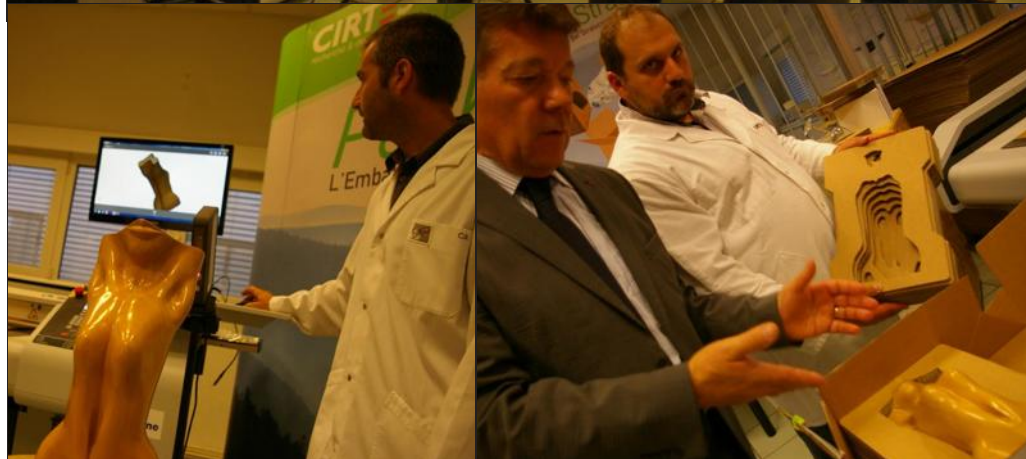
■ Scanner de la pièce à emballer, analyse par un logiciel spécifique, traçage puis découpe de la contre-forme : voilà le concept que le Cirtes met au service de La Poste.
